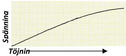
Spännings/Töjningdiagram vid böj
